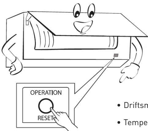
**OPERATION-RESET** knappen på innedelen starter eller stopper enheten uten bruk av fjernkontullen.
