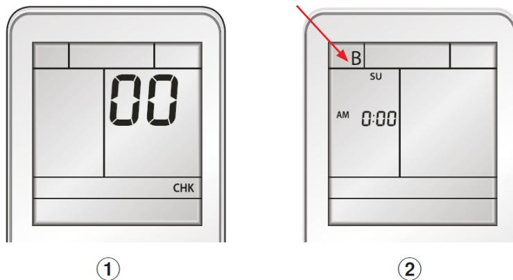
6. Test fjernkontrollen mot begge innedelene. Den skal kun klare å styre innedel B.
